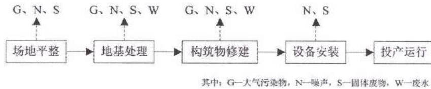
图2-3 项目污水处理厂施工期工艺流程图
