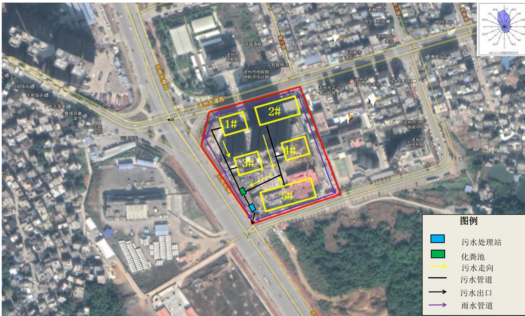
附图4 雨、污水管道铺设情况
